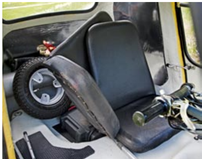
Mopedbilen körs med ett vanligt styre med handgas. Thomas har placerat en växelspak på golvet istället för original växlingshandtag på styret. Styret har panel för signal, lyse och blinkers.
