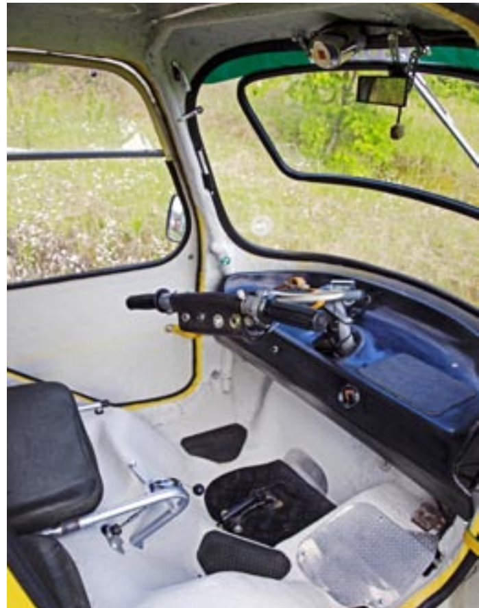
Mopedbilen körs med ett vanligt styre med handgas. Thomas har placerat en växelspak på golvet istället för original växlingshandtag på styret. Styret har panel för signal, lyse och blinkers.
