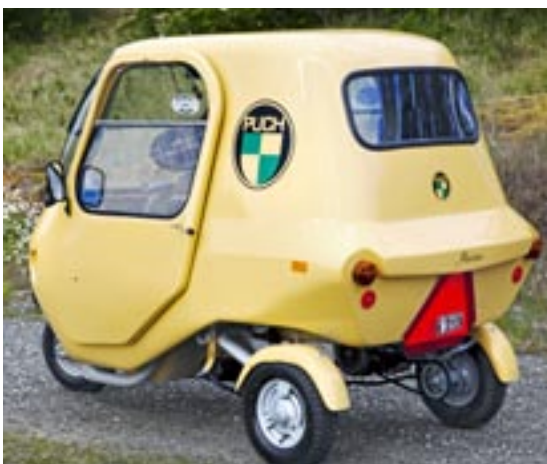
Mopedbilen körs med ett vanligt styre med handgas. Thomas har placerat en växelspak på golvet istället för original växlingshandtag på styret. Styret har panel för signal, lyse och blinkers.
